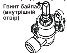
Кран без системи захисту від витоків газу
